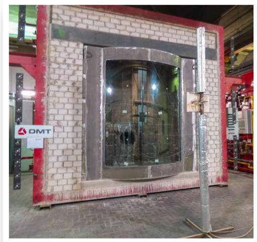
Brandofen 4 x 4 m – Außenansicht
