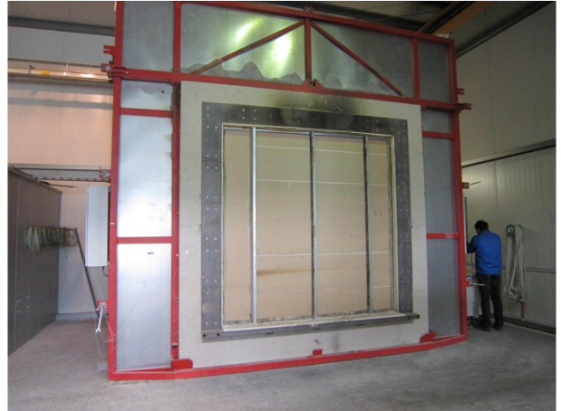
Brandofen 4 x 4 m – Verkleinerung auf 2,42 x 2,48 m (Prüfung von Trennflächen des Typs A, B und F
