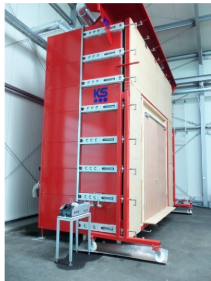
Rauchprüfkammer 5 x 5 m – Seitenansicht
