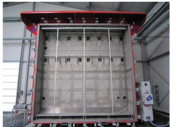
Rauchprüfkammer 5 x 5 m – Innenansicht
