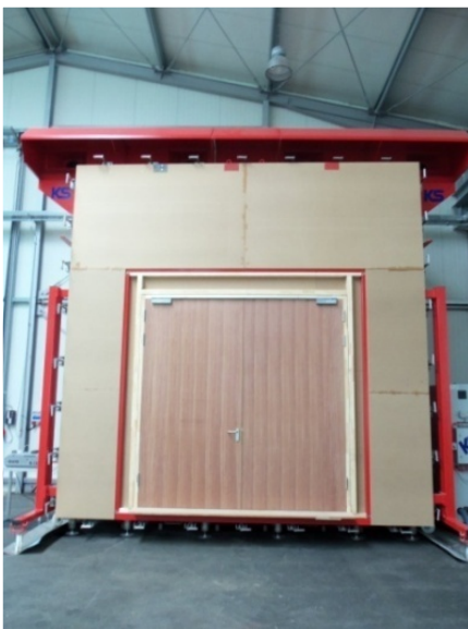
Rauchprüfkammer 5 x 5 m – Frontansicht Beispiel Verkleinerung auf 3,4 x 3,4 m
