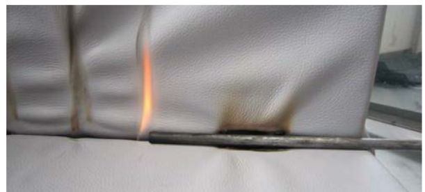
Brandversuch Gasflamme Polstermöbel
