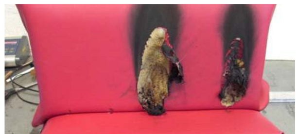
Ergebnis eines Brandversuches Polstermöbel
