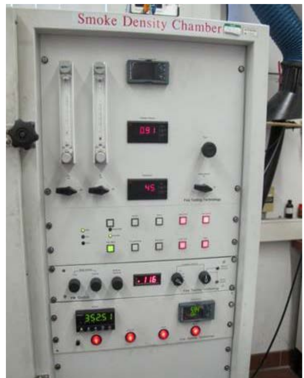
Rauchdichte- und Toxizitätskammer nach EN ISO 5659-2
