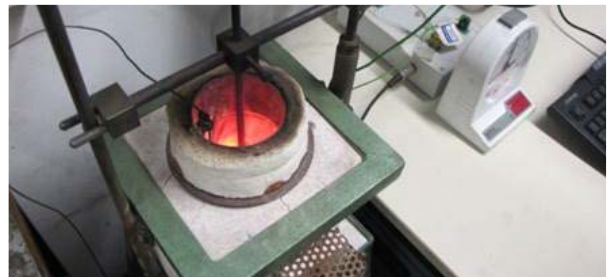
Verlauf des Brandversuches im Nichtbrennbarkeitsofen
