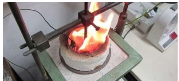
Reaktion eines Materials im Nichtbrennbarkeitsofen
