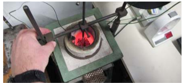
Beginn des Brandversuches im Nichtbrennbarkeitsofen
