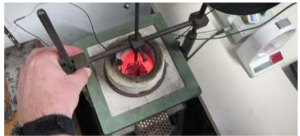
Beginn des Brandversuches im Nichtbrennbarkeitsofen
