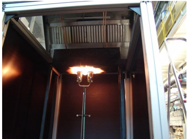
Beladung eines Aerosolabscheiders nach LPS 1263
