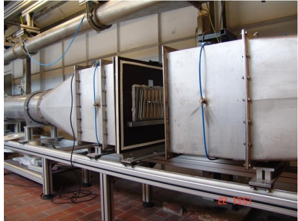
VDI 2052-1 Fraktionsabscheidegradbestimmung im DIN EN 1822 Prüfstand
