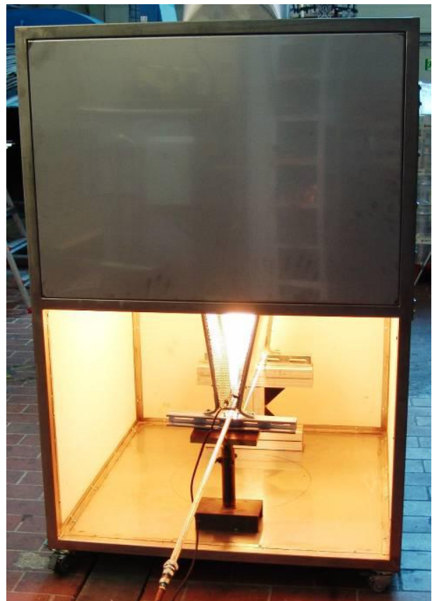
DIN 18869-5 Prüfstand: Rückseite mit Brenner
