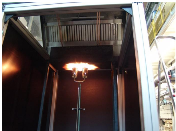
Beladung eines Aerosolabscheiders nach LPS 1263
