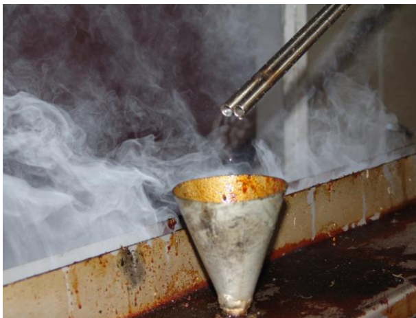
Prüfaerosol bei der Prüfung nach UL 1046
