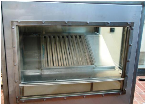
Wrasen- oder Aerosolabscheider im DIN 18869-5 Prüfstand
