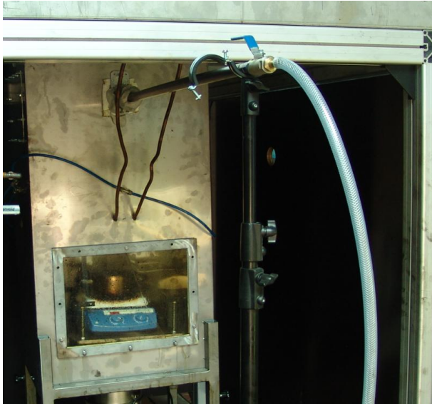
Aerosolprobenahme bei der Prüfung nach der Prüfnorm LPS 1263
