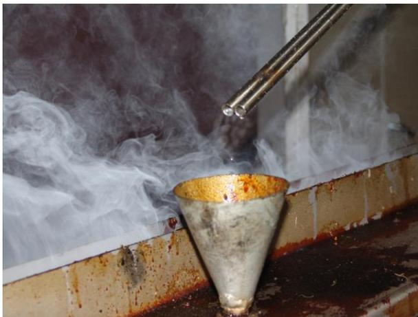
Prüfaerosol bei der Prüfung nach UL 1046
