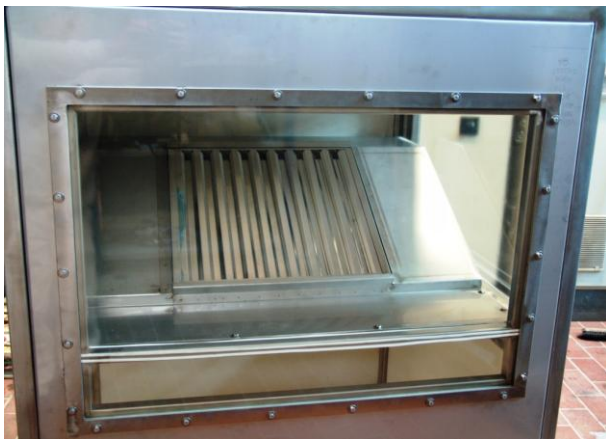
Wrasen- oder Aerosolabscheider im DIN 18869-5 Prüfstand
