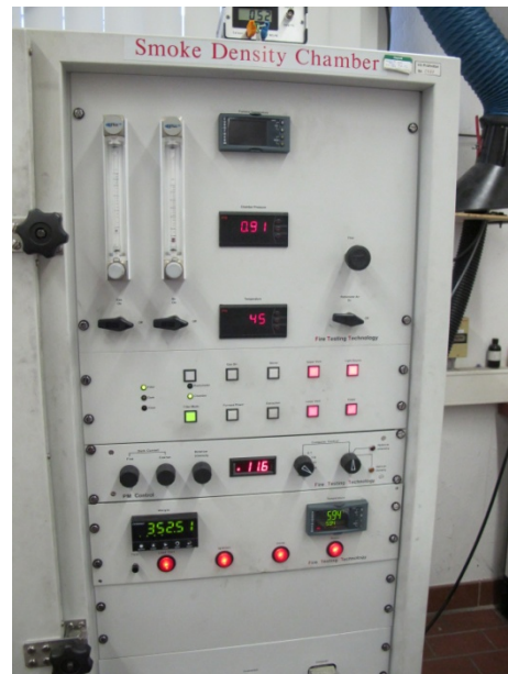
Rauchdichte- und Toxizitätskammer nach EN ISO 5659-2
