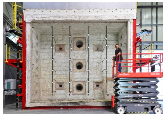
Neuer Brandprüfofen Vorderansicht
