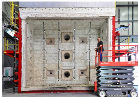
Neuer Brandprüfofen Vorderansicht
