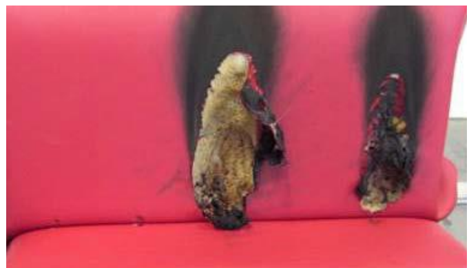
Ergebnis eines Brandversuches Polstermöbel
