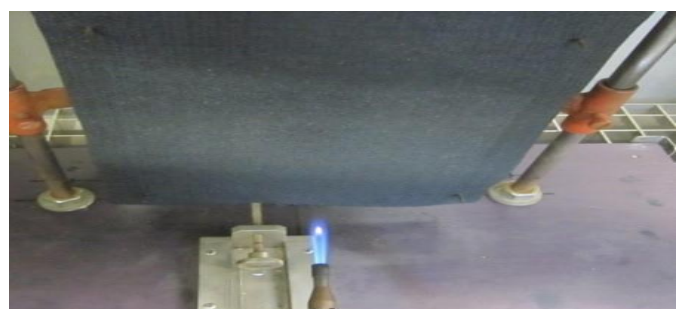
Vorbereitung Kantenbeflammung Vorhangstoff
