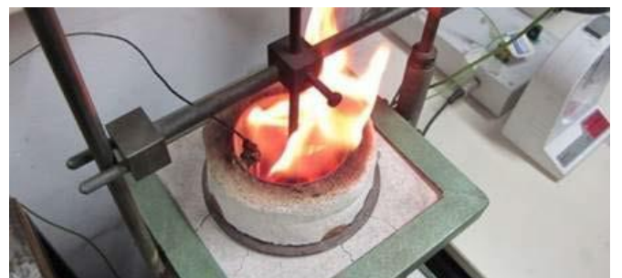
Reaktion eines Materials im Nichtbrennbarkeitsofen
