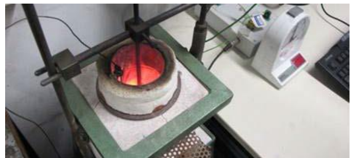
Verlauf des Brandversuches im Nichtbrennbarkeitsofen
