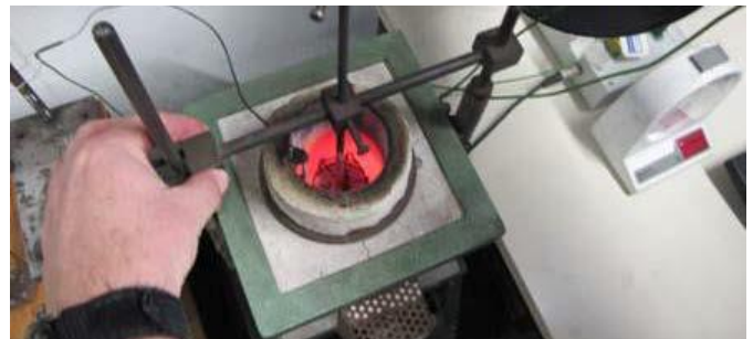
Beginn des Brandversuches im Nichtbrennbarkeitsofen
