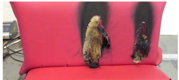
Ergebnis eines Brandversuches Polstermöbel
