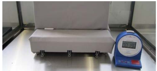
Versuchsaufbau Zigarettentest Polstermöbel
