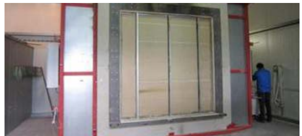
Brandofen vertikal 4 x 4 m – Verkleinerung auf 2,44 x 2,5 m (B x H)
