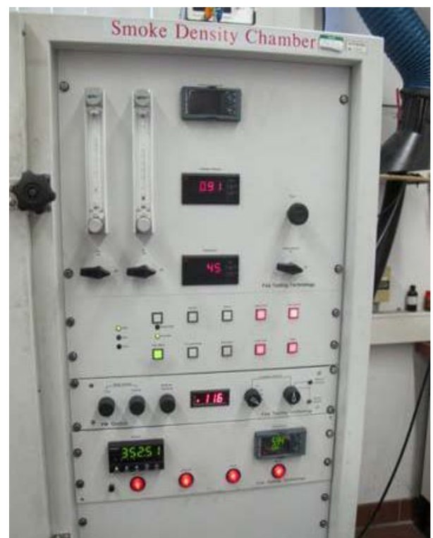
Rauchdichte- und Toxizitätskammer nach EN ISO 5659-2
