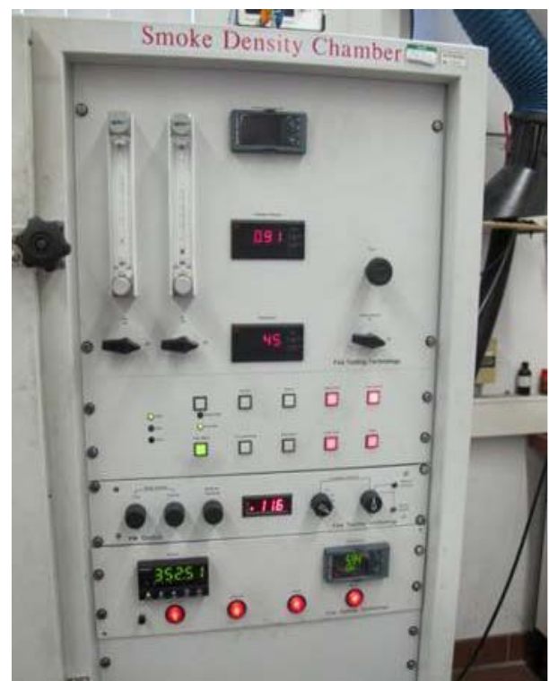
Rauchdichte- und Toxizitätskammer nach EN ISO 5659-2
