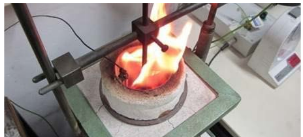
Reaktion eines Materials im Nichtbrennbarkeitsofen
