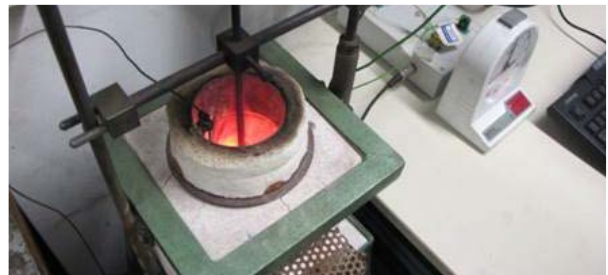
Verlauf des Brandversuches im Nichtbrennbarkeitsofen
