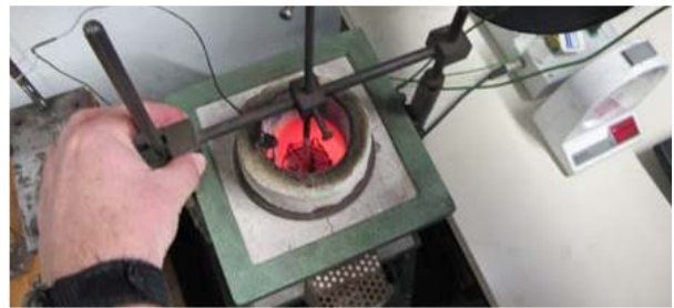
Beginn des Brandversuches im Nichtbrennbarkeitsofen
