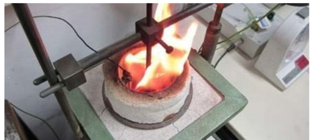
Reaktion eines Materials im Nichtbrennbarkeitsofen
