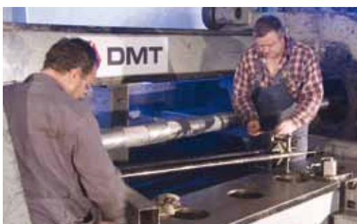
Vorbereitung zur Dehnungsmessung an einem Seil
